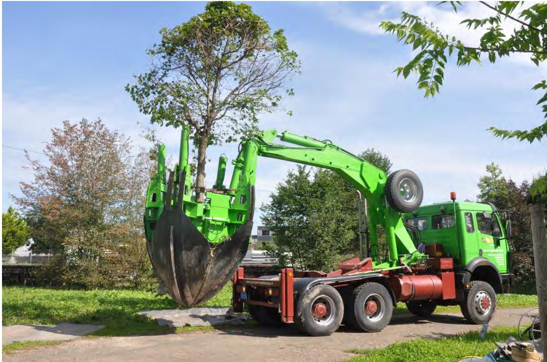
*Abb. 3: Baumverpflanzung mit der Rundspatenmaschinen. Foto BMB Group-Arbor Swiss AG.*
